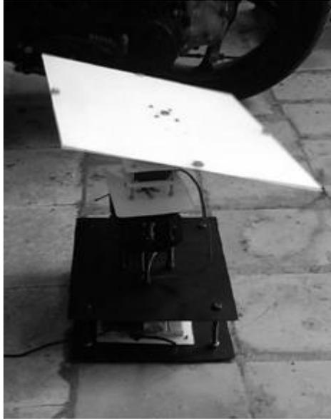
Gambar 10. Solar Tracker device pada posisi awal
