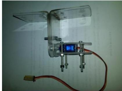
Gambar 7. Servo vertikal
