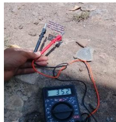
Gambar 7 Pengukuran menggunakan 100 dioda zener di hubung paralel
