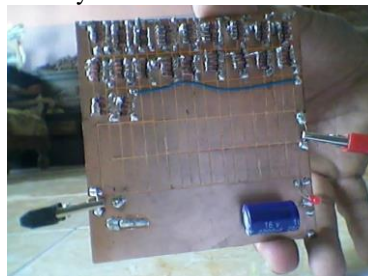
Gambar 10 Rangkaian uji tegangan pada lampu LED pada sel surya berbahan dioda zener
