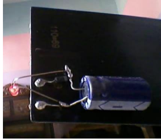
Gambar 9 Rangkaian uji tegangan lampu LED pada sel surya tipe monokristal berukuran 118x63mm
