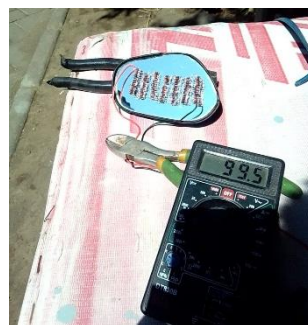
Gambar 8 Pengukuran menggunakan 5 dioda zener di hubung paralel kemudian di seri sebanyak 20 rangkaian
