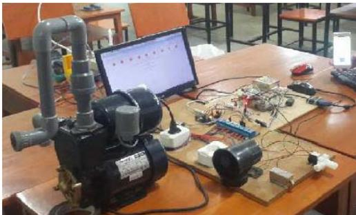
Gambar 9. Mini PC Raspberry Pi dan Peralatan Listrik yang dikendalikan
