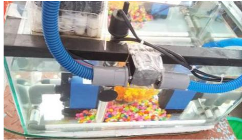
Gambar 7 Rangkaian Generator Turbin Air Mini
