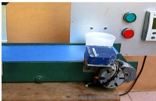
Gambar 6. Gelas yang sudah diisi berhenti di ujung belt conveyor
