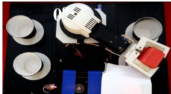
Gambar 15 Penetapan sudut mekanik warna merah lengan robot
