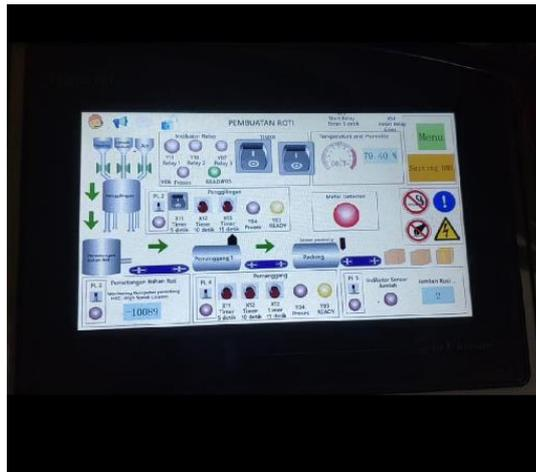
Gambar 10. Tampilan Desain HMI (*Human Machine Interface*) pada layar HMI
