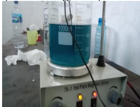
Gambar 1 Proses pencampuran bahan bakar menggunakan magnetic stirrer
