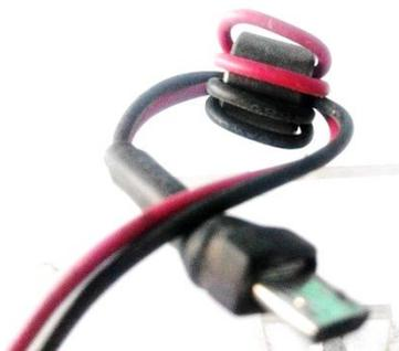
Gambar 4 Modifikasi kabel micro usb male
