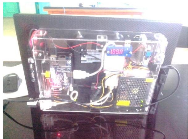
Gambar 11 Tampak bagian belakang Mini Desknote Banana Pi yang telah dirakit lengkap
