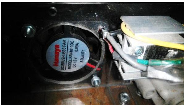
Gambar 9 Modul regulator tegangan LM7812 yang diaplikasikan pada fan cpu
