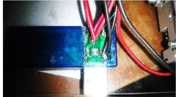
Gambar 7 Modifikasi Modul Display Monitor Tegangan dan Arus
