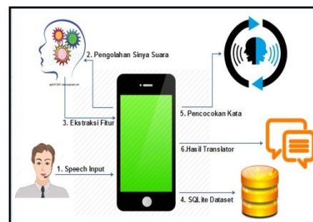
Gambar 4. Alur Kerja Sistem Yang Akan Dibangun
