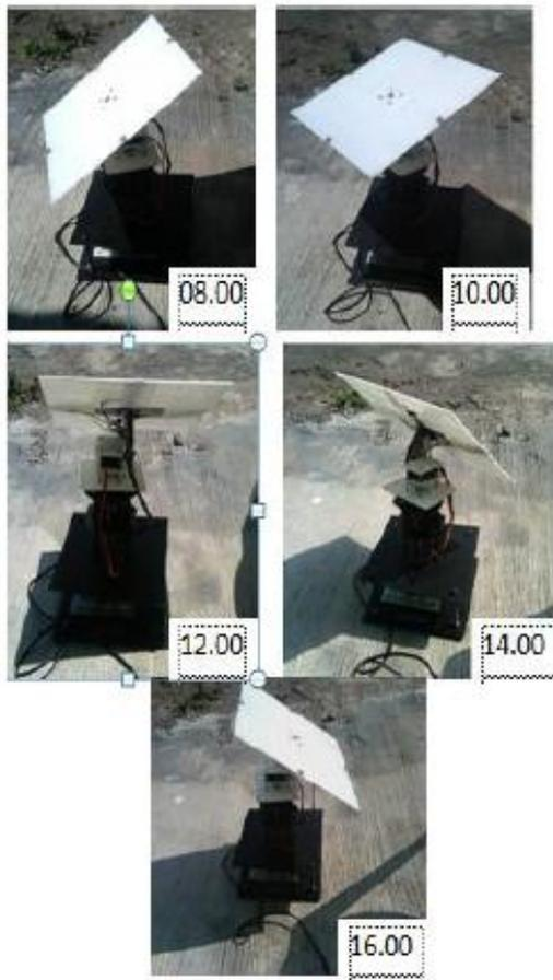
**Gambar 7. Pengujian Solar Tracker**
