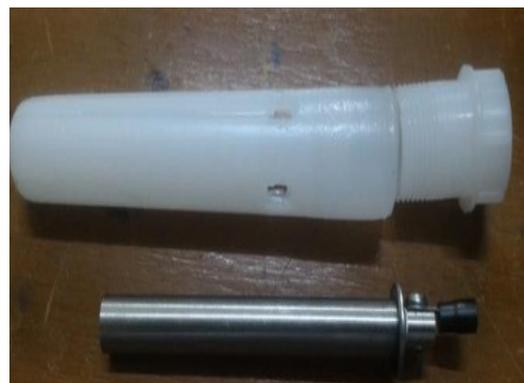
Gambar 13. Sensor Elektroda lilin
