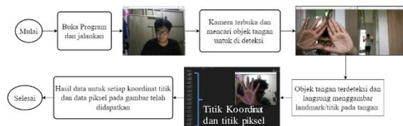
Gambar 2. Alur Sistem Deteksi Gestur Tangan
