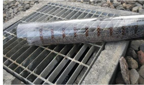
Gambar 3. Kerikil Penyebab Pompa Macet
