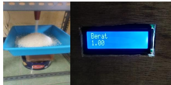
Gambar 6. Pengujian Load Cell
