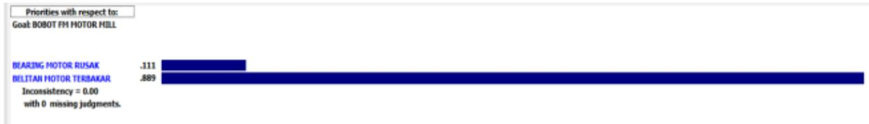
Gambar 6. Perbandingan *Bearing Motor* Rusak dan Belitan Motor Terbakar
